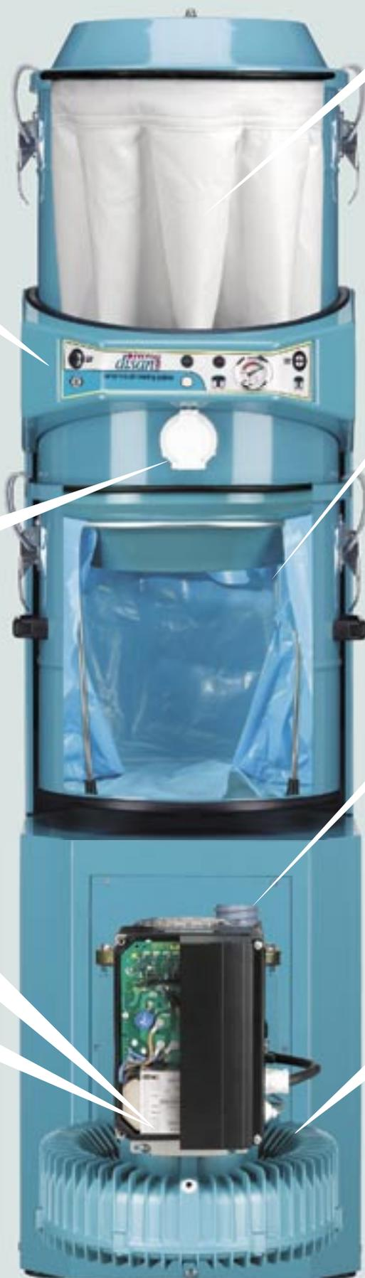
**FILTERSYSTEM** - Der großflächige, sternförmige Filter aus hochwirksamem Spezialgewebe erzielt die besten Filterergebnisse und trägt für den hohen Wirkungsgrad unser Compact Anlagen bei. Aufgrund der Bauweise der Filterkammer, lässt sich der am Filter haftende Staub bei Bedarf mit dem manuellen Filterrüttler problemlos entfernen. Bei Verwendung des automatischen Filterreinigungssystems gewährleistet man eine dauerhafte und gleich bleibende Saugleistung. Der Sternfilter ist bei 30° waschbar.
