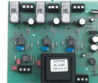
Steuermodul für Kaskadenschaltung von 3 Motoren IS03
